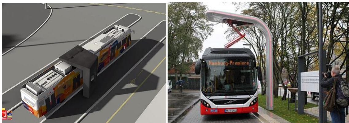
7.25. Prikaz načina punjenja električnih "shuttle" autobusa
