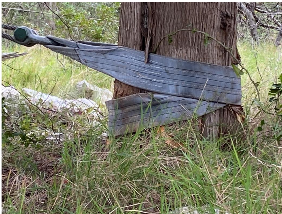
Slika 6. Učvršćivanje žičare na pridanku debla te zaštita trakama
